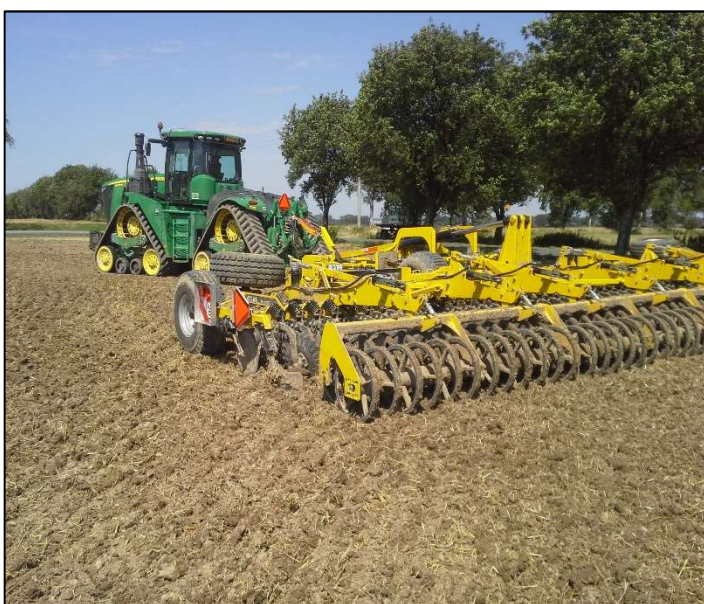
Agregace inovované pracovní soupravy při hlubším zapravení posklizňových zbytků obilní předplodiny pro následný výsev ozimé řepky (varianta bez úpravy dusíkaté bilance posklizňových zbytků)
