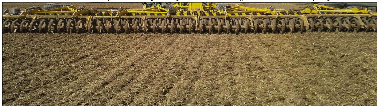
Povrch půdy po zpracování inovovaným talířovým kypříčem krátké konstrukce s výplňovým válcem
