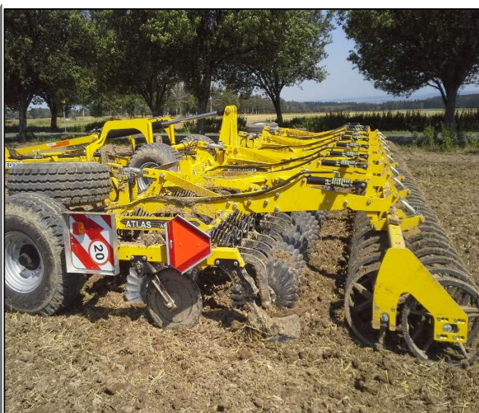
Krátká konstrukce kypříče - 2 řady velko-průměrových talířů a zakončení výplňovým utužovacím válce 2 řadovým
