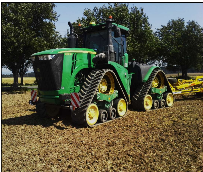
Tahač s pásovými pojezdovými sekcemi pro agregaci inovovaného talířového kypříče krátké konstrukce pro hlubší kypření půdy
