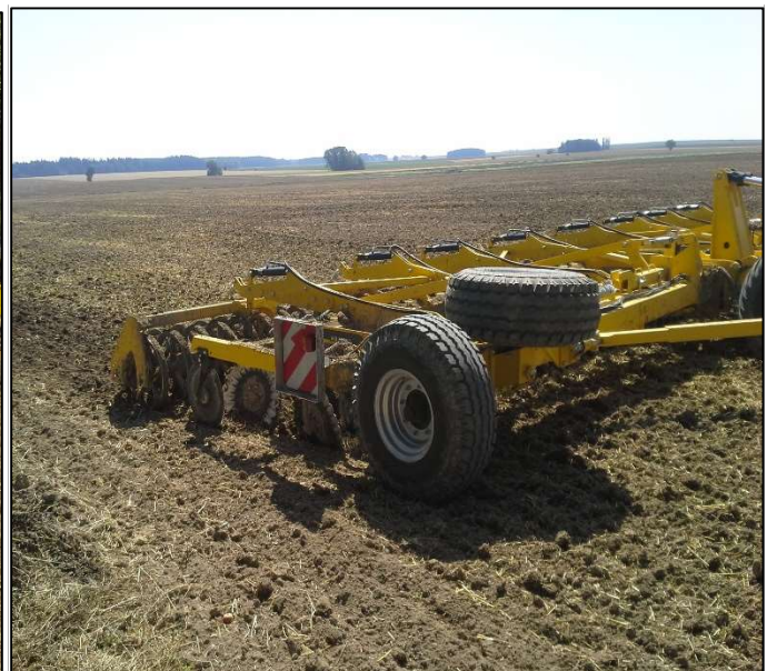
Agregace inovované pracovní soupravy při hlubším zapravení posklizňových zbytků obilní předplodiny pro následný výsev ozimé řepky (varianta bez úpravy dusíkaté bilance posklizňových zbytků)
