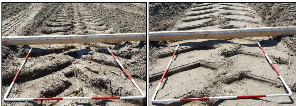
Obr. 17. Stopa na povrchu předsetově připravené půdy od pojezdových jednotek po přejezdech současného kolového traktoru a inovovaného pásového tahače (15. 11. 2017, vlevo kolový, vpravo pásový tahač)
