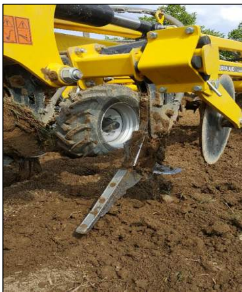
Polo-parabolická slupice s dlouhým dlátem a krátkými bočními křídly
