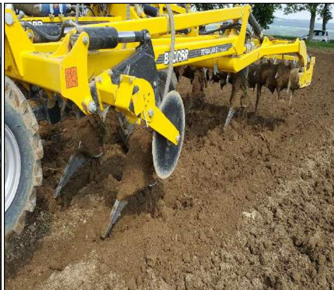
Hlubkový dlátový kypříč (pluh) s polo-parabolickými slupicemi osazené v rozteči 40(43)cm se svody pro tzv. systém hnojení půd do rýh, přednostně fosforečnými hnojivy. Pracovní hloubka slupic s vysoce otěruvzdornými dláty 25 – 55 cm
