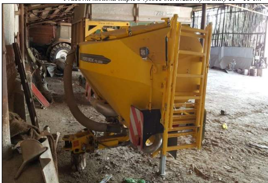
Aplikační zásobník granulovaných hnojiv pro vyvinutou technologii profilového hnojení půd, předsetového hnojení mikro-horizontu seřového lůžka, aplikace vyrovnávací dávky dusíku v technologii péče o půdu po sklizni.
