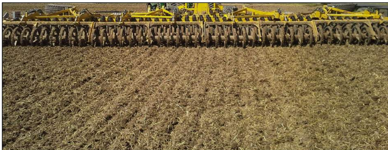
Obr. 16. Povrch zpracované půdy vyvíjenou technologií agresivní podmítka a zapravení posklizňových zbytků inovovaným talířových kypřičem (25. 8. 2017)
