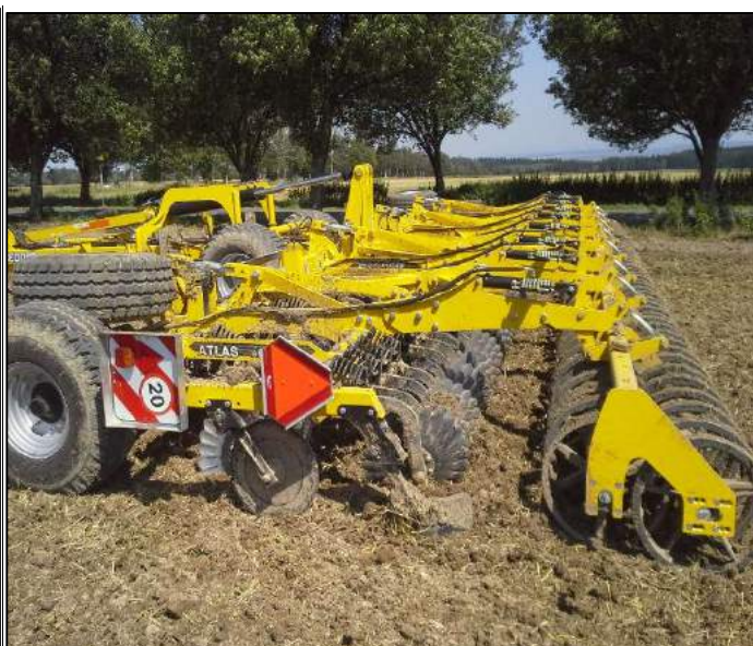
Krátká konstrukce kypříče - 2 řady velko-průměrových talířů zakončení výplňovým utužovacím válce 2 řadovým
