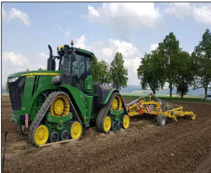
Agregace inovovaného hlubkového dlátového kypříče (pluhu) s pořízeným inovovaným tahače s pásovými pojezdovými sekcemi profilového vyvíjející nižší tlak na půdu, snižující zhutnění půdy
